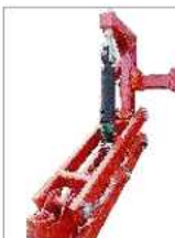
Опора передних колес рамы на параллелограмме
