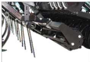
Узел успокоитель (боронка и каток)
