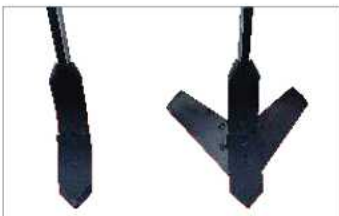
Сборный глубокорыхлитель и сборная лапа культиватора серии К
