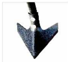
Стрельчатая лапа 230 мм
