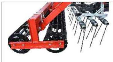
Навесное оборудование: прикатывающий двойной каток и трехрядная пружинная борона
