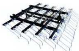
с Г-образным пружинным зубом (штригель)
