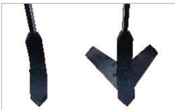
Сборный глубокорыхлитель и сборная лапа культиватора серии КД
