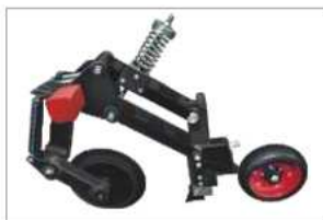
Высевающий анкер на параллелограмме с разрезным диском
