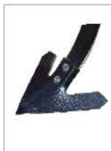
Стрельчатая лапа 260 мм
