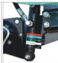
Цилиндр дожима секции
